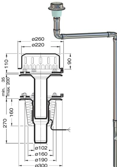
**Begleitheizung:** Wir empfehlen, nach Prüfung Dachabläufe und Leitungen in frostgefährdeten Bereichen gegebenenfalls mit einer bauseitigen Begleitheizung zu versehen.
