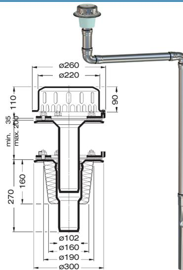
mit Wärmedämmung und Heizung
